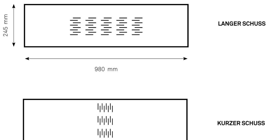
Die gepunkteten Linien zeigen die Richtung des Schussfadens. Der Schuss ist der dünnere Faden, der durch die Kette, den dickeren Faden, gezogen wird. Je nach Richtung des Schusses ergibt sich ein anderer Effekt.
