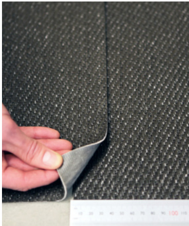
BKB 1.4 cm Überlappung von 2 Bodenfliesen und Doppelschnitt.
